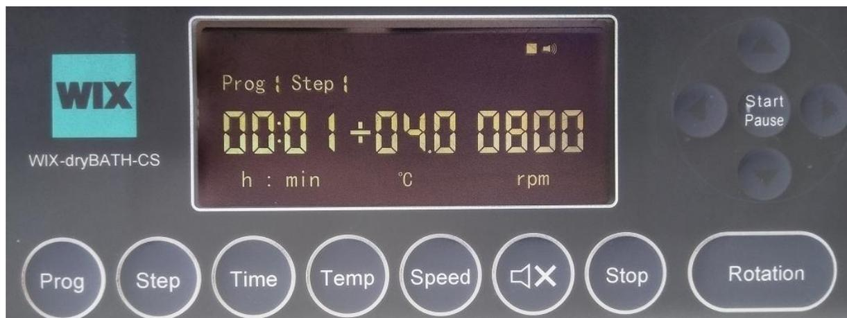
喇叭按键可以打开或关闭仪器的提示音。提示音打开时屏幕右上角显示提示音打开图标，如上图所示，提示音关闭时屏幕右上角显示提示音关闭图标。
