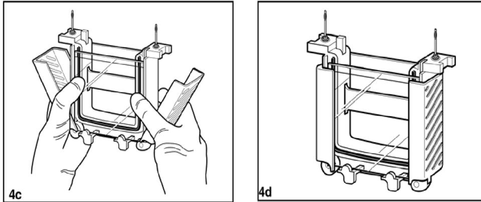
注：凝胶板必须以短玻璃板向内方式放置于夹胶框两侧。同时，夹胶框需要 2 块胶板组合形成组件。如果运行奇数胶（1 或 3 块胶），则须使用单胶替代板（见图 4b）。
