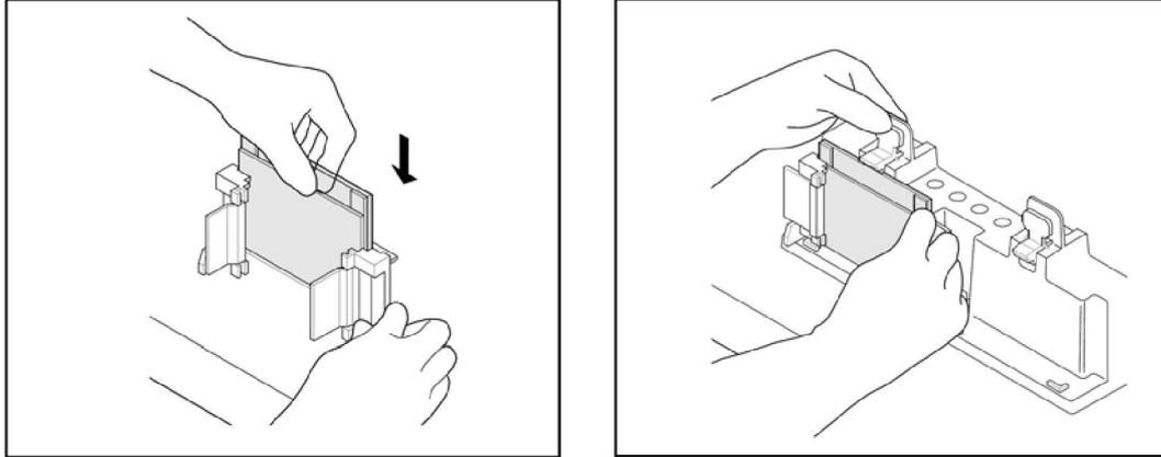
图 2：灌胶架与制胶底座的组装
