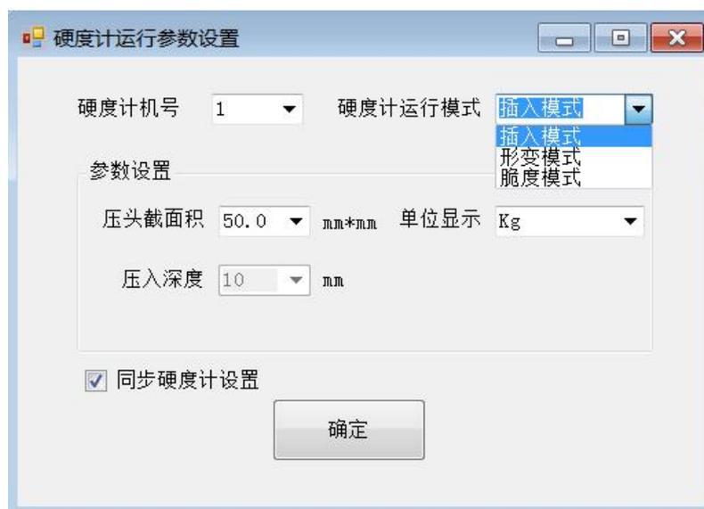
说明：压头压入深度默认选择 10 毫米。压头截面积根据所配的压头选择。
