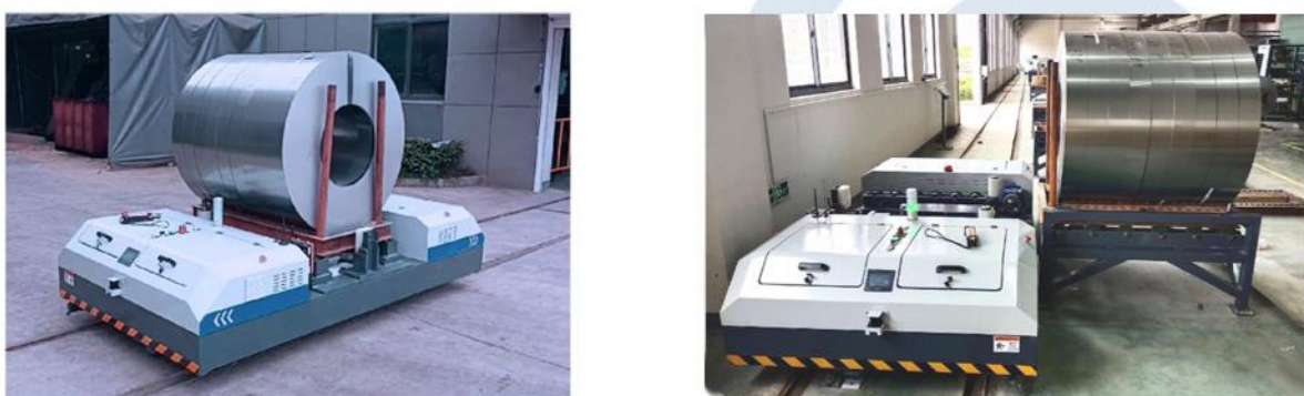
某铁芯制造有限公司钢卷转运RGV
