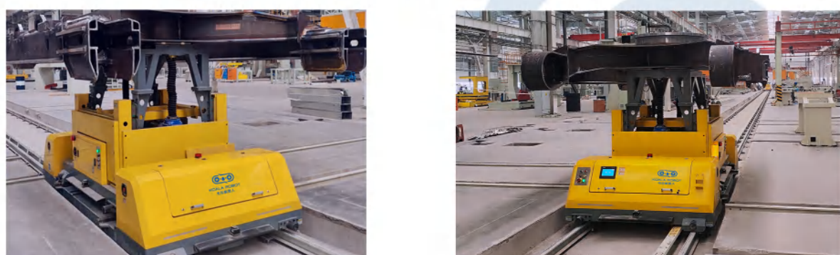
某工程机械厂车架焊接产线RGV
